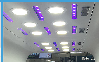
Stérilisation avec lampe UV-C
